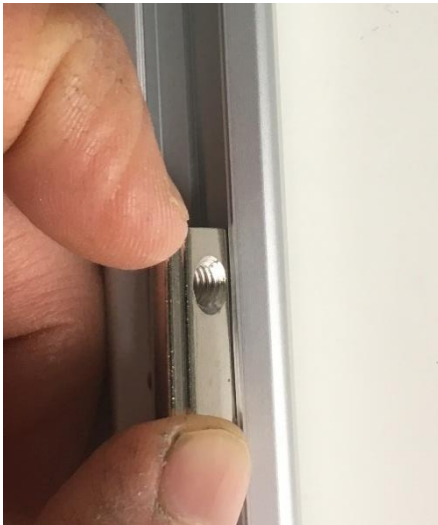
Figure 2. Insert slot nuts (D) into Aluminium track (B).
